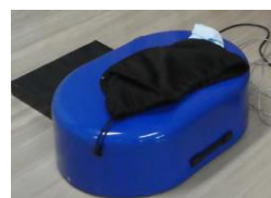
図8 三次元自動靴型計測機
